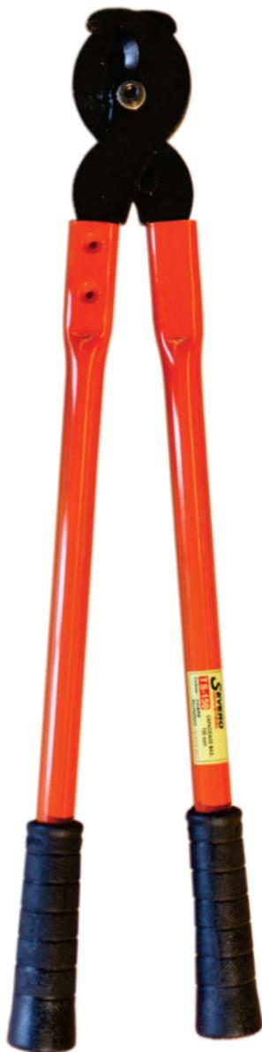
O alicate **TS-150** é um alicate corta-cabos que foi projetado para cortar cabos de alumínio e de cobre sem alma de aço, permitindo um corte sem rebarbas, possibilitando a colocação imediata dos terminais. Tem capacidade de corte de cabos de até 150 mm<sup>2</sup>.
